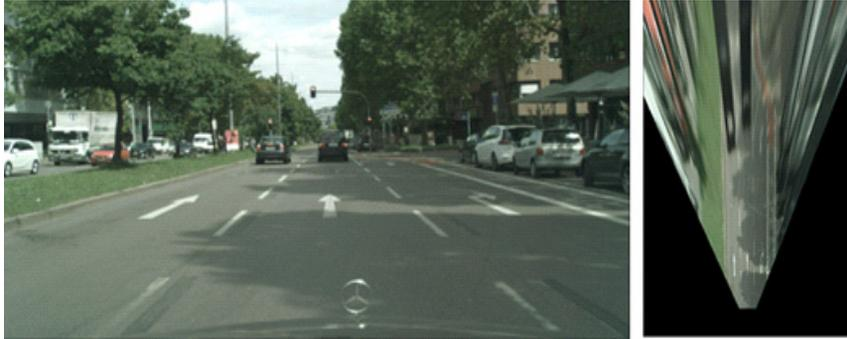
하지만 이러한 IPM 기반 접근법은 변환된 point들이 한 평면(지면)에 존재한다는 가정에 크게 의존하므로, 건물, 차량 및 보행자와 같은 지면에 붙어있지 않은 물체까지 정확하게 변환하는 것은 어렵습니다(그림 2). 따라서 일부 방법은 이런 지면 위에 위치하지 않는 물체에 대한 왜곡을 줄이기 위해 각 픽셀의 semantic 정보를 활용합니다. OGMs[6]은 차량의 footprint segmentation 결과를 PV에서 BEV로 변환할 때 이용하여, 한 평면에 존재한다는 가정을 따르면서도 차체가 지면보다 위에 위치하면서 발생하는 왜곡을 방지합니다.
